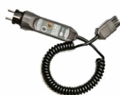
Adapter WS-01 der die Messung aus-löst (UNI-Schu- ko-Buchse)
